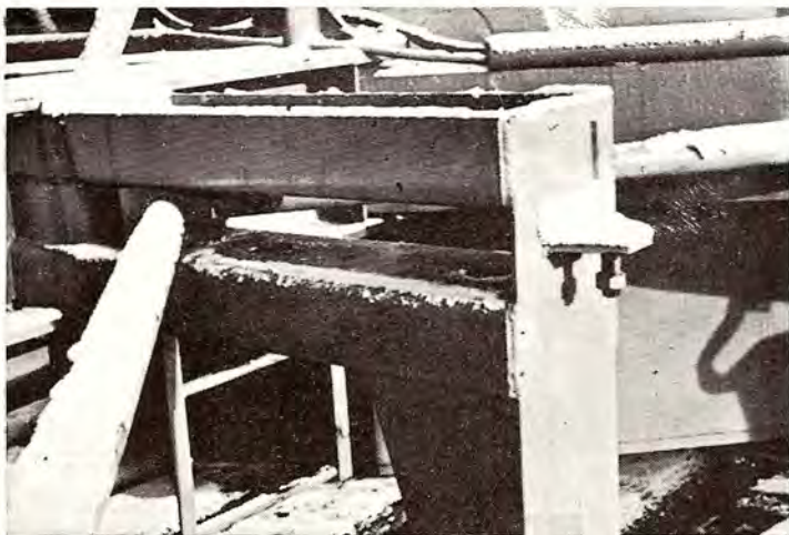
Bild 3: Das Spreizen der Laufwerke erfolgt durch die auf dem Bild gezeigte Steckvorrichtung; hier in hinterster Stellung.
