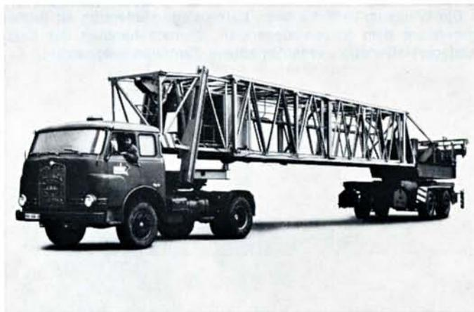
Abb. 3: Liebherr Nadelauslegerkran Form 45 A/65 mit max. 8 t Tragkraft zeigt die Vorteile des Transportes der größeren Nadelauslegerkrane gegenüber den Katzauslegerkranen, da letztere zerlegt transportiert werden müssen. (Werk-Foto: Liebherr Werk I)
