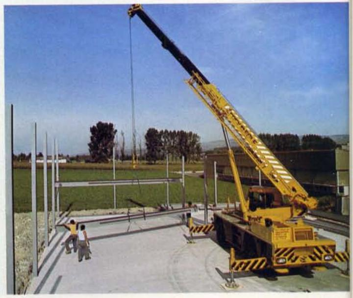
selmotor mit 144 kW (240 PS) Leistung angetrieben und erreicht auf der Strasse eine maximale Geschwindigkeit von siebzig Kilometer pro Stunde. Für die Strassenfahrt können Allradantrieb und Allradlenkung auf Zweiradeinsatz umgeschaltet werden. Bei
