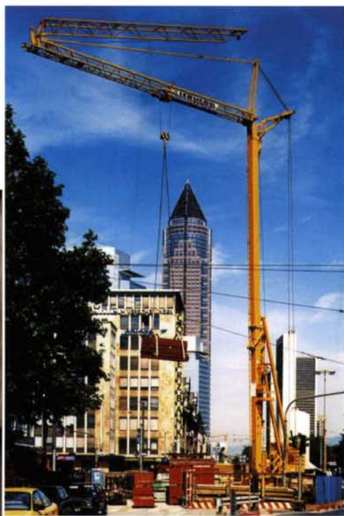
Multifunktional: Je nach Baustellensituation läßt sich der Ausleger in voller Länge horizontal, steil gestellt oder auch eingeklappt betreiben. Sogar in Steilstellung bleibt die Funktion der Laufkatze voll erhalten.
