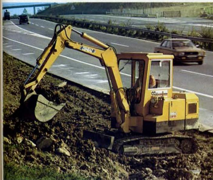
senen, heizbaren Kabine erfolgt die Bedienung über eine Zwei-Hebelsteuerung für die Baggerbewegungen und die Oberwagenschwenkung. Mit separaten Bedienungshebeln lassen sich die Ausleger-schwenkung, das Fahrwerk und das Planierschild manövrieren.
