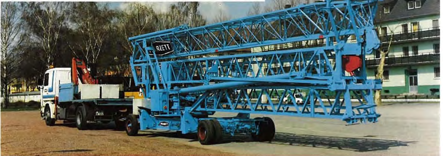
TK 2510 im Straßentransport
