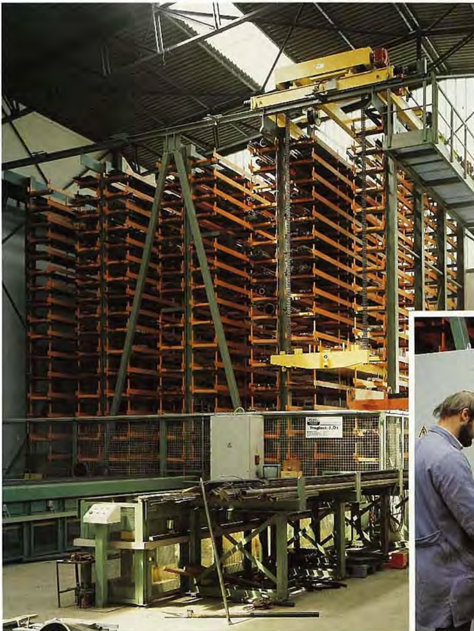
Das Langgutlager mit automatischer Beschickung, Kapazität 500 t
