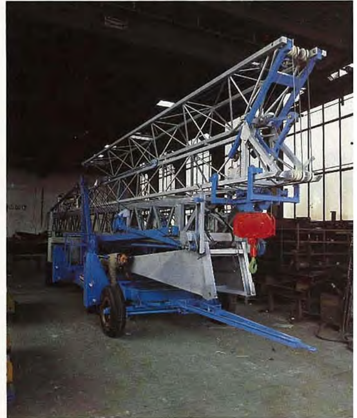
Endmontage eines Kranes
