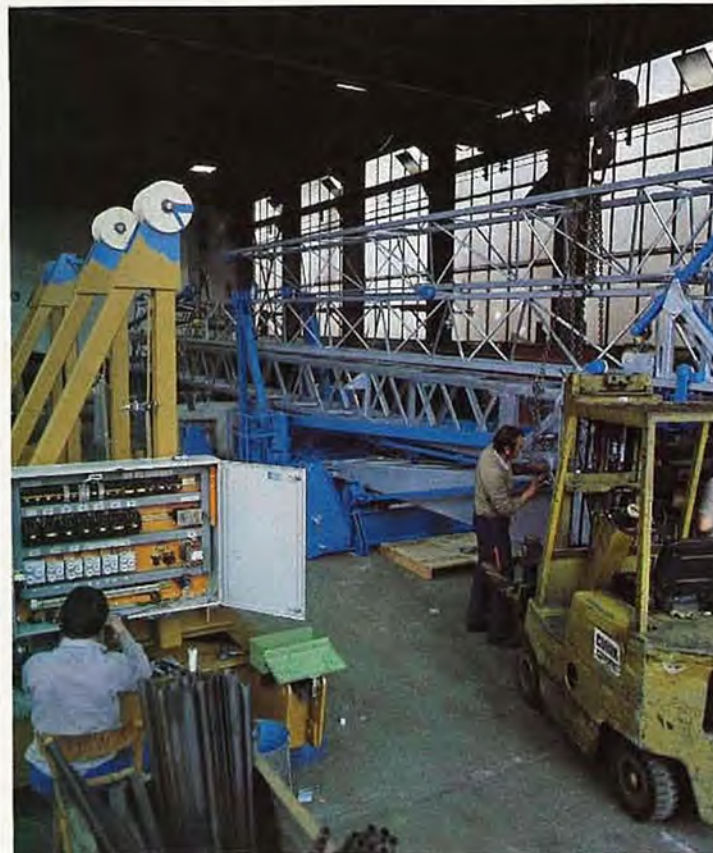
Einbau der Elektrosteuerung am Kran
