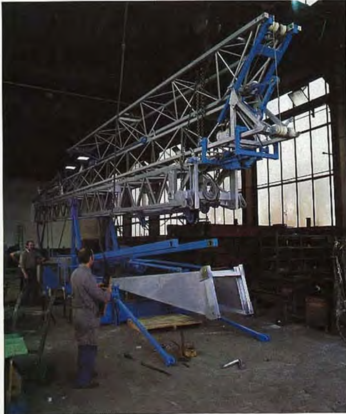
Aufsetzen des Turmpaketes auf den Unterwagen
