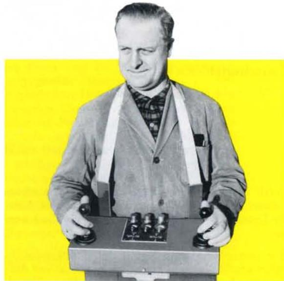
sind sämtliche Getriebe automatisch abgeschaltet. Eine rote Kontrolllampe zeigt eine Überlastung des Kranes sofort an. Bei allen diesen Vorteilen ist das Steuerpult sehr klein, handlich und leicht ausgeführt.
