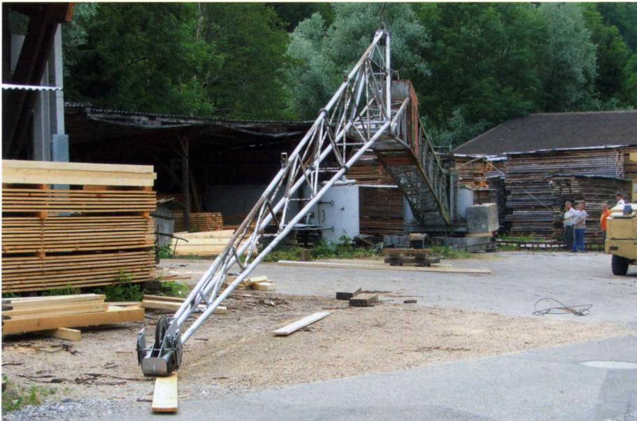
Dieser Brun MTK 18 M, Baujahr 1957, kam 2005 von Kienberg SO in die KBM-Auffrischung und -Ausstellung. Die Ausladung reicht bis 18 Meter; die Tragkraft beträgt 850 Kilogramm bei 6 Meter (AG Kran- und Baumaschinenmuseum e. V.).
