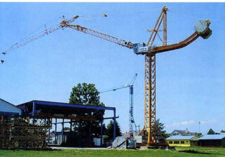
Cobra Crane 263 C mit 47 m Ausladung und einer Tragkraft von 5,6 t. Diese neueste Schweizer Turmdrehkranentwicklung vereinigt sowohl einen Klappausleger sowie einen Wippausleger als Option. Das Gegengewicht wird zum Momentenausgleich auf der runden Gegenauslegerlaufbahn je nach Ausladung verfahren.
