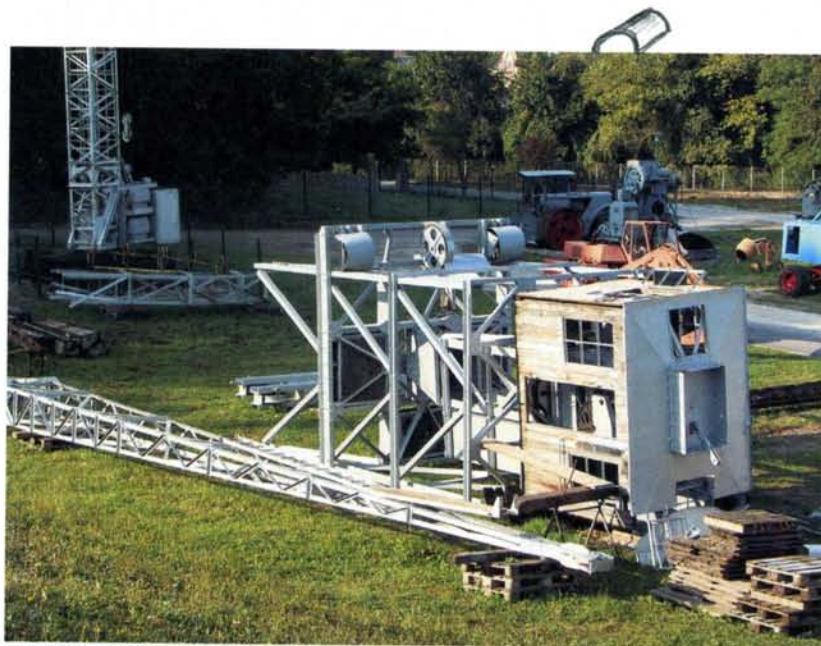
2 von 10 ausgestellten Museumsstücken: (links) Die Krane Brun TK-B mit Biegebalkenausleger und Liebherr Form 14 A wurden originalgetreu restauriert und im Museumspark Rüdersdorf bei Berlin aufgebaut. Oben der Brun TK-B bei der Restaurierung (Foto D. Moeller)
