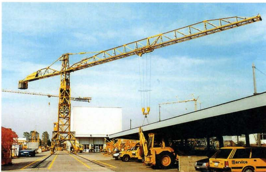
Oben: Weitz-G-280-Grossturm- drehkran mit maximal 20 t Tragkraft. Ab 1964 wurden in der Schweiz solche Giganten eingesetzt. (Foto P. Meyer)
