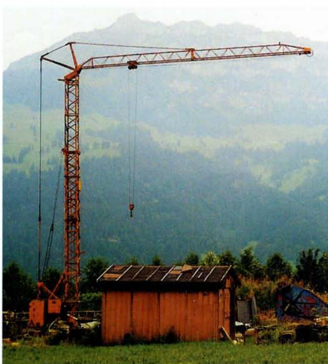
Cadillon-Schnellmontagekran Typ 3 D, einer der ersten Vertreter einer neuen Schnellmontagekrangeneration Anfang der sechziger Jahre, konzipiert für schnellen Baustellenwechsel. (Foto: P. Meyer)
