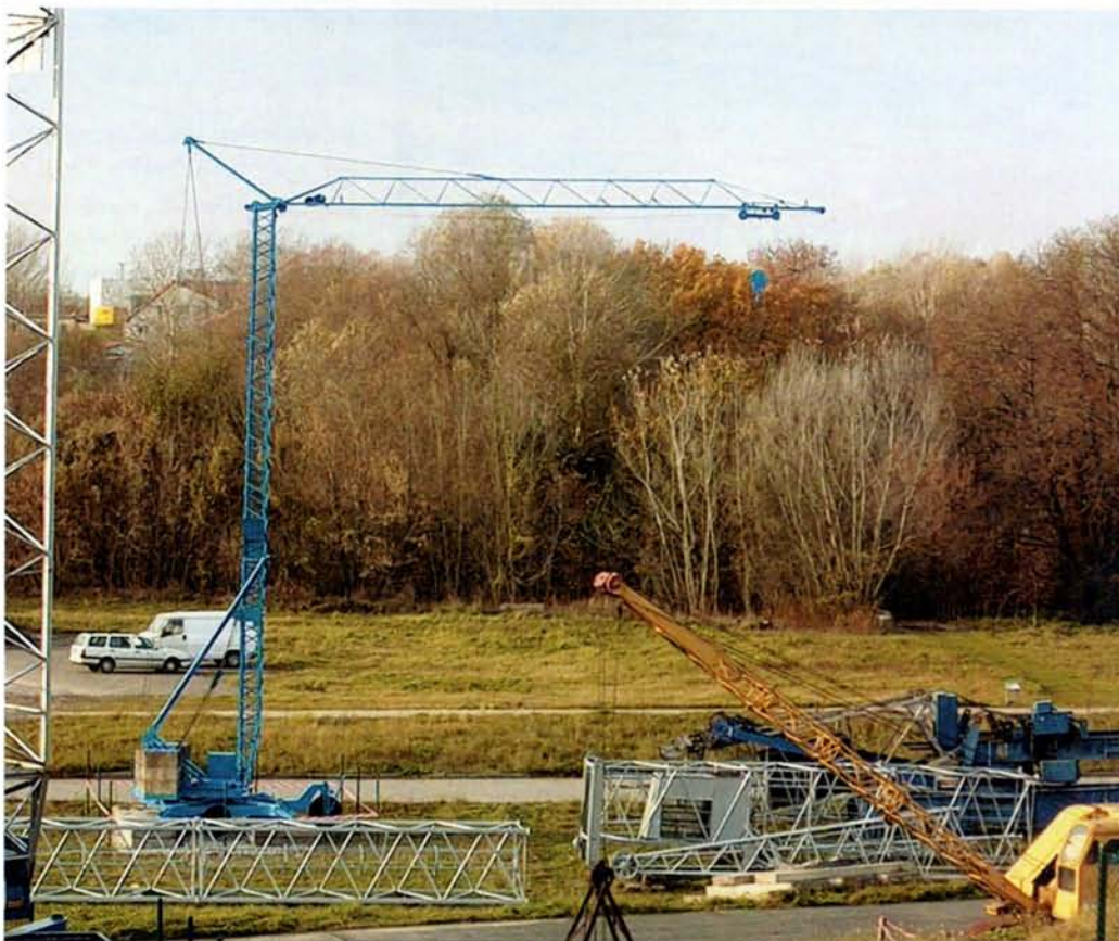
Unten: Boilot-Schnellmontagekran BP 650 mit Klappturm, ein Vertreter der ersten Klappturmkranen. (Foto: W. Schreiber)
